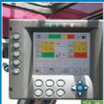
Monitor a colori di facile uso e lettura per le funzioni del limitatore di carico e del motore.
