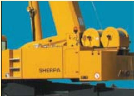
Secondo argano con fune da 165 m, diam. 18 mm. Capacità di tiro 5000 daN.
